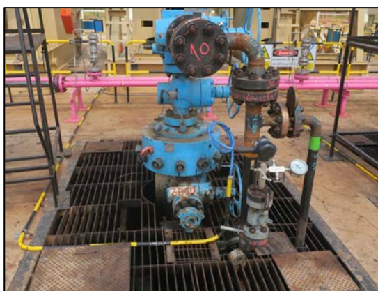
ชุดวาล์วหัวบ่อ (Christmas Tree) และบ่อเก็บน้ำบริเวณหัวบ่อ (Well Celler Pit)
